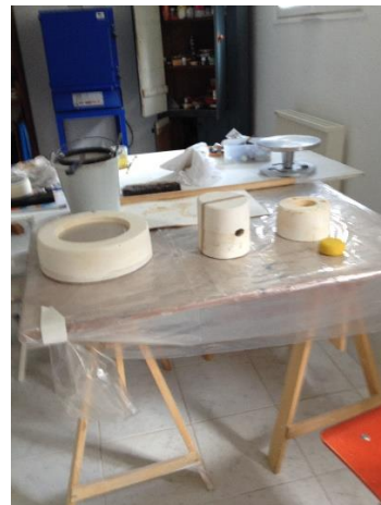
Faïence liquide coulée dans les moules en plâtre
